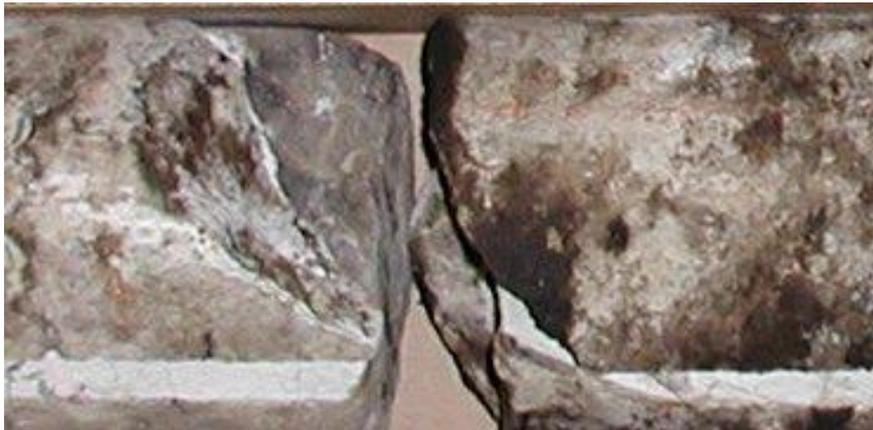
Рис. 7. Открытая макротрещина, отмеченная на глубине 1387,95 м скв. 39516 Западно-Ленинградской площади
