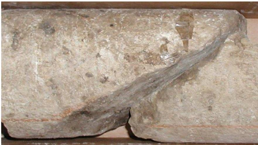
Рис. 6. Открытая макротрещина, отмеченная на глубине 1386,6 м скв. 39516 Западно-Ленинградской площади
