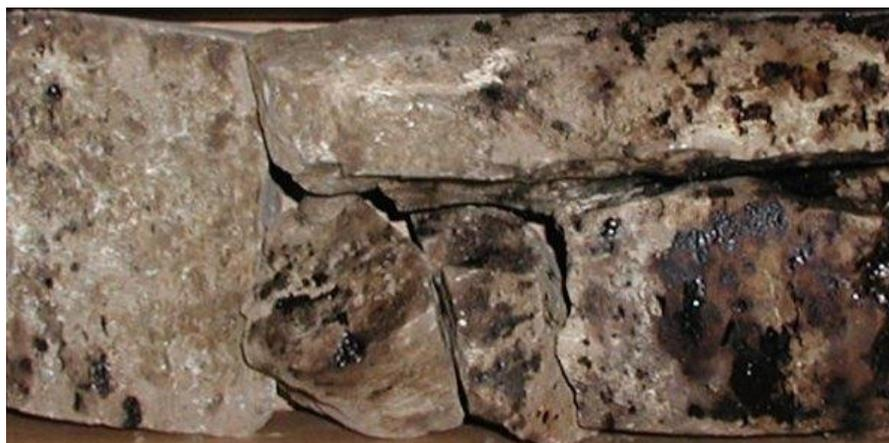
Рис. 8. Открытая макротрещина, отмеченная на глубине 1390,4 м скв. 39516 Западно-Ленинградской площади
