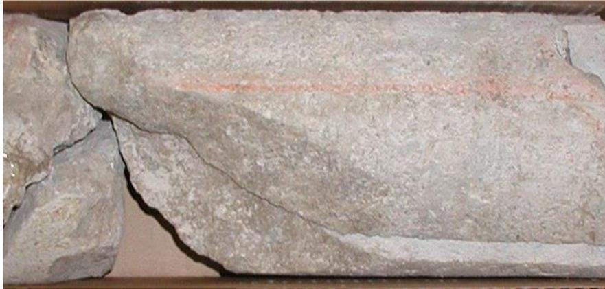
Рис. 5. Открытая макротрещина, отмеченная на глубине 1384,95 м скв. 39516 Западно-Ленинградской площади
